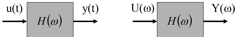
Fig. ... Rappresentazione ingresso-uscita di un sistema dinamico regolato da equazione differenziale lineare.
